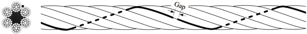
解説図 6—素線を貼り付け断面積変化を与えた対比試験片の説明図
