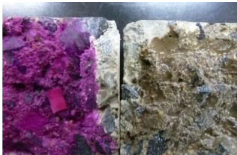
解説図 2—中性化促進試験後の断面へ フェノールフタレイン溶液（左）と 硝酸銀溶液を噴霧した結果（右）
