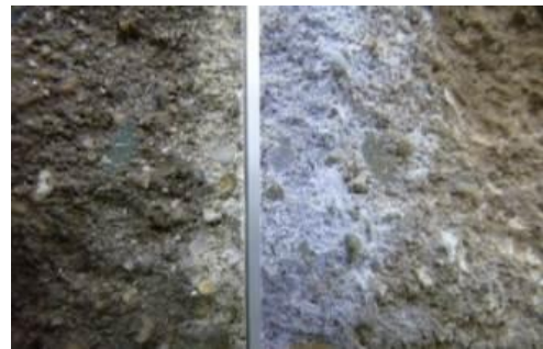
解説図 3—中性化によって地色のままとなった 領域（左）と塩化物イオンによって白色に 呈色した領域（右）
