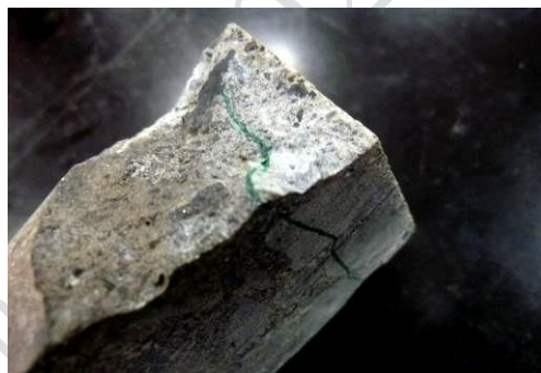
解説図 5—割裂面と乾式カッタでの切断面とで白色に呈色した部分の末端が一致している様子
