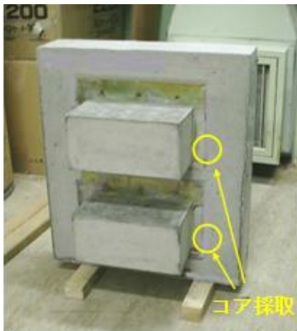
解説図 1—小型試験体による促進中性化試験
