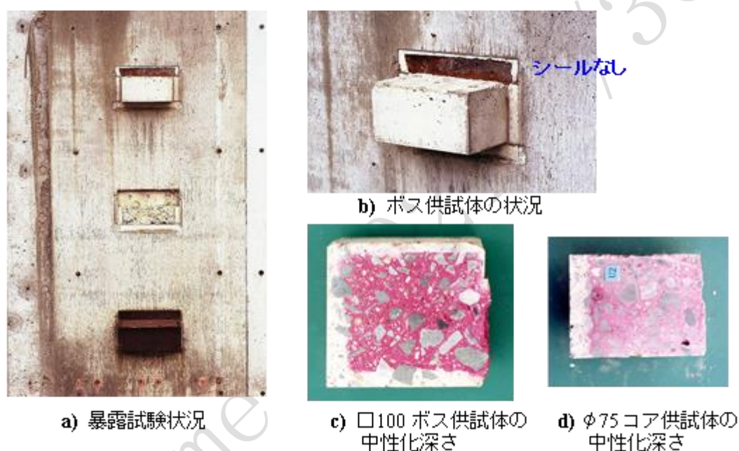
解説図 1—15 年経過の中性化深さ試験結果[1]
