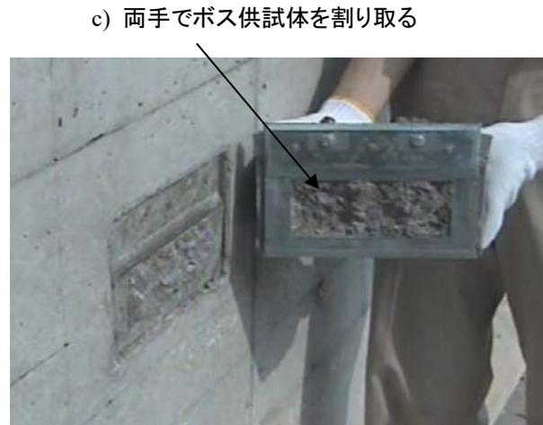
図4—ボス供試体の割り取った後の状況
