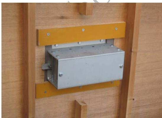
解説図 13—若材齢時に強度試験を行う場合のボス型枠の取付け方法（例）
