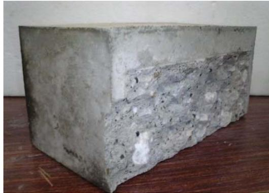
解説図 29—割取り面の一部が欠損（例）
