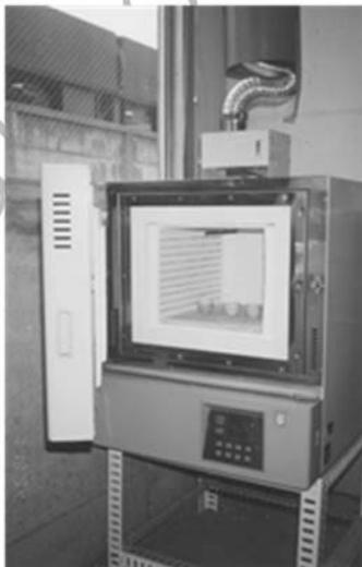
解説図 11—排気・吸気機構がある電気炉
